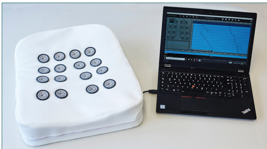
In insgesamt 16 Kanälen zeichnet das an der TU Graz entwickelte Aufnahmegerät die Lungengeräusche während der Atmung auf. © TU Graz
